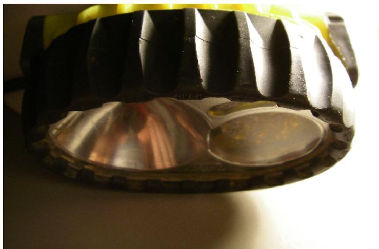
boîtier de pile ne seront modifiés. Pour procéder à l'assemblage il est nécessaire de démonter le module en tournant la chenille dans le sens indiqué par la petite flèche précédent « open ».
