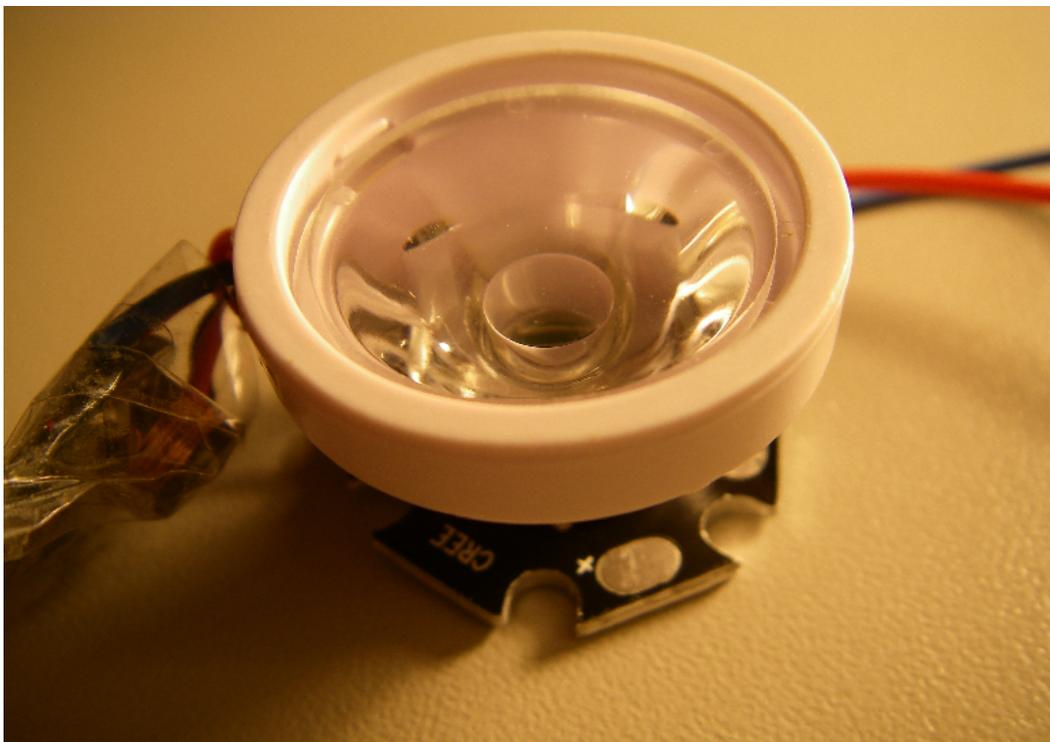
Il ne reste plus qu'à fixer l'optique sur la LED, juste un clipsage ajusté et vous avez déjà fini le module « faisceau ».
