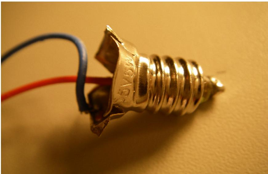
Coté circuit de commande il n'y a pas à se tromper, la soudure doit s'effectuer coté plaques sur les 2 disques de cuivre concentriques. Le disque central est le + il doit être connecté sur le culot de la douille, sur la LED les pastilles sont détrompées par les symboles + et -. Pour éviter des courts circuits avec les composants situés à proximité, j'ai enroulé de scotch le régulateur.
